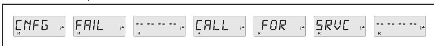
Figure 43: schéma message Erreur de configuration
